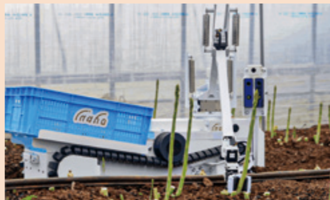
自社開発したアスパラガスの自動収穫ロボット。アスパラガス1本を12秒で収穫する。スマホでも操作でき、最大7時間連続稼働・夜間収穫も可能
